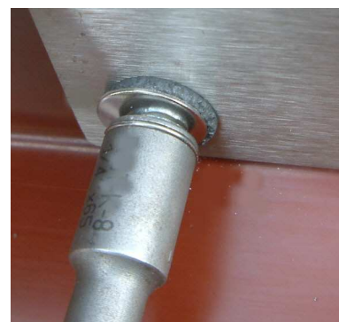
Při sešroubování dbejte na lehké stlačení těsnění – při větších počtech kusů pracujte s hloubkovým dorazem!
